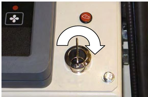
5. Aguarde de três a cinco minutos até que o motor e o sistema hidráulico esquentem.
