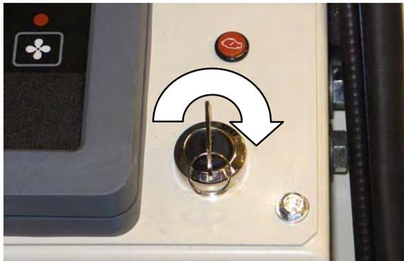
**PARA A SEGURANÇA:** Ao iniciar a máquina, mantenha o pé no freio e o pedal de direção na posição neutra.
