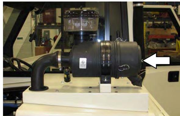
Remova o elemento do filtro. Limpe cuidadosamente a tampa terminal e a parte interna do alojamento com pano úmido. Limpe as superfícies de vedação do alojamento.
