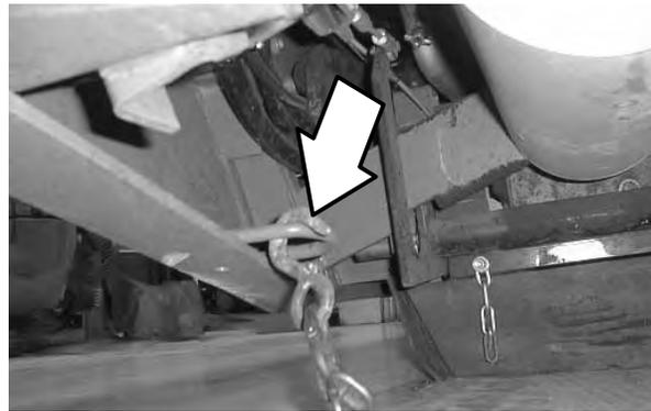
4. Gire a válvula de bypass 90° a partir da posição normal antes de guinchar a máquina para colocá-la no caminhão ou reboque. Consulte *EMPURRAR OU REBOCAR A MÁQUINA* neste manual. Certifique-se de que a máquina esteja centralizada.
