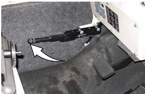
*NOTA: Se o operador não estiver no assento, o freio de estacionamento deve ser engatado ou a máquina desliga automaticamente depois de 2 segundos.*
