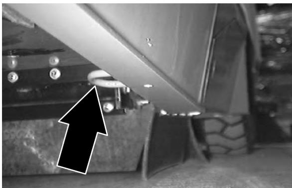
7. Se a superfície de carregamento não for plana ou estiver a mais de 380 mm (15 pol.) do chão, use um guincho para descarregar a máquina.
