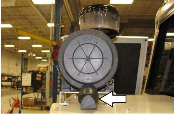
Pressione o botão de reajuste na extremidade do indicador para reajustar o indicador do filtro de ar depois de substituir o filtro de ar.
