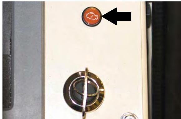
**LUZ DE FILTRO HIDRÁULICO ENTUPIDO**
