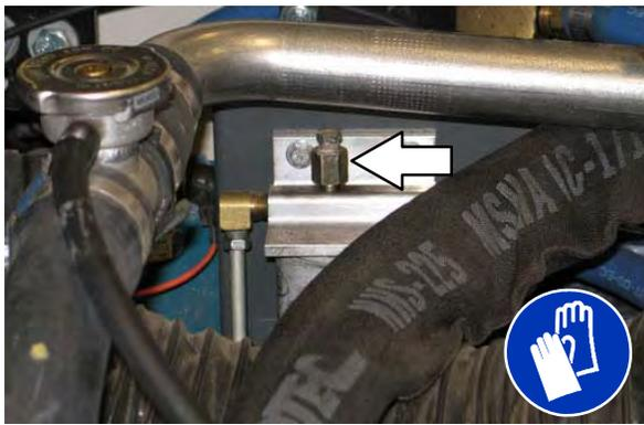
Feche o encaixe do separador de água / combustível depois que um fluxo constante de combustível começa a drenar.
