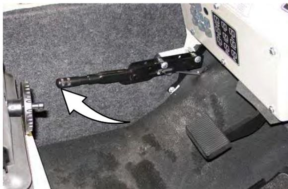
Empurre a alavanca do freio de estacionamento para baixo para soltar o freio de estacionamento.
