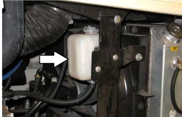
Verifique as mangueiras e abraçadeiras do radiador após cada 250 horas de operação. Aperte quaisquer abraçadeiras frouxas. Substitua mangueiras e abraçadeiras danificadas.
