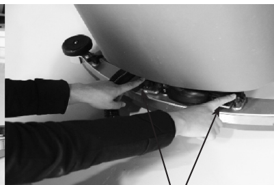
Solte o parafuso de aperto Girando no sentido anti-horário
