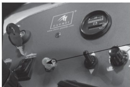
Fusível de proteção
