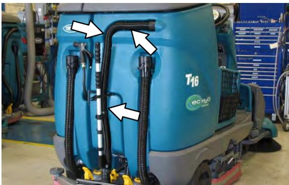
12. Prenda o cinto do tubo de aspiração no tanque de solução para prender o tubo de aspiração / mangueira de aspiração do rodo à máquina.
