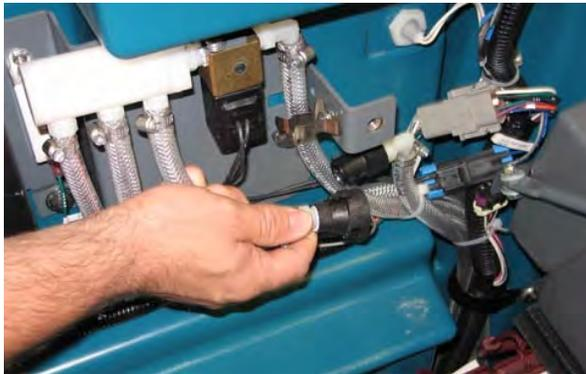
9. Conecte a mangueira de drenagem à mangueira do coletor do ec-H2O, desconectada da mangueira de saída no passo anterior.
