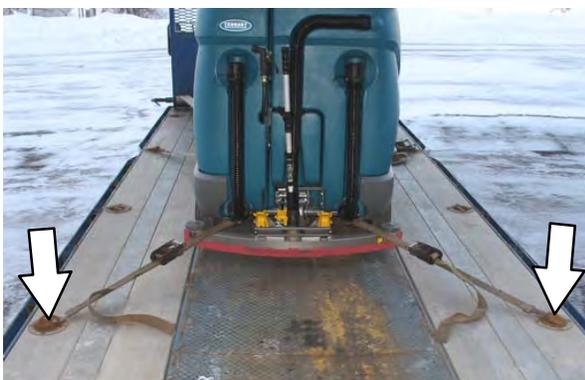
7. Se a superfície de carregamento não for plana ou estiver a mais de 380 mm do chão, use um guincho para descarregar a máquina.
