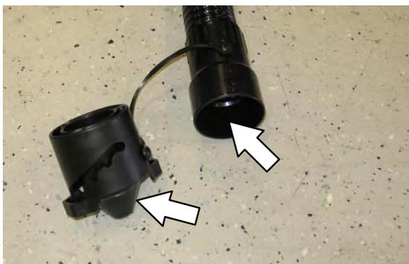
7. Gire a bainha do dreno para fechar e prenda o tubo de drenagem de volta no tanque de solução.
