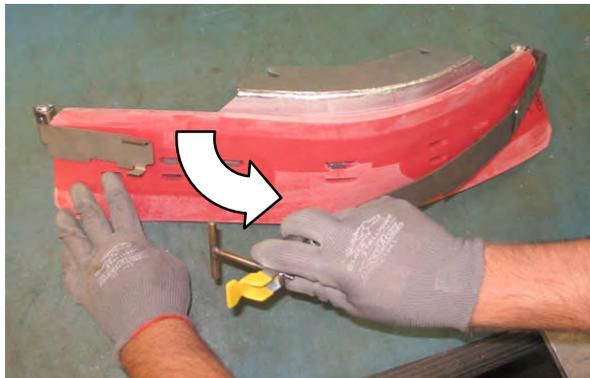
*OBSERVAÇÃO: observe quais fendas foram instaladas no chassi do rodo antes de remover o rodo.*
