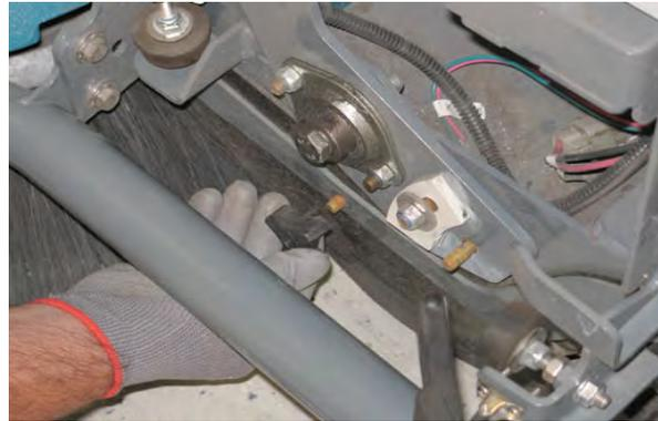
6. Remova a placa lateral e a saia lateral do conjunto de pré-arrimento.
