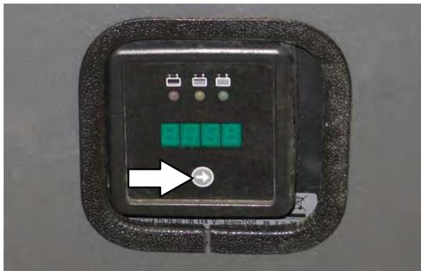
Para alterar a configuração, desconecte o carregador e levante a ponta do adesivo do visor para acessar os interruptores. O cabo do carregador deve estar desconectado ao redefinir.
