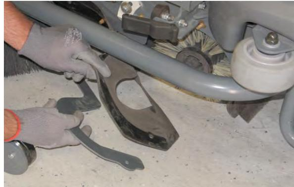
7. Remova a escova cilíndrica e substitua-a por uma nova.
