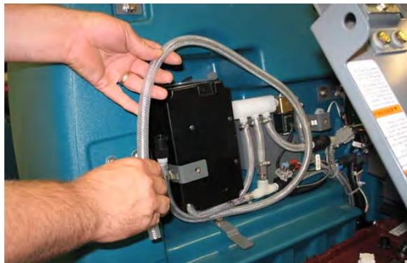
4. Desconecte a mangueira de saída da mangueira conectada ao coletor do ec-H2O.
