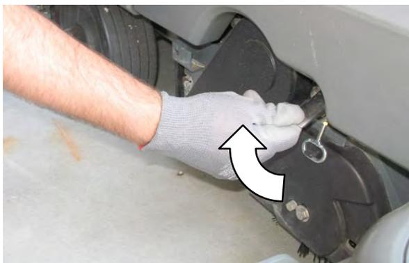
3. Remova a placa de apoio do cabeçote de lavar.
