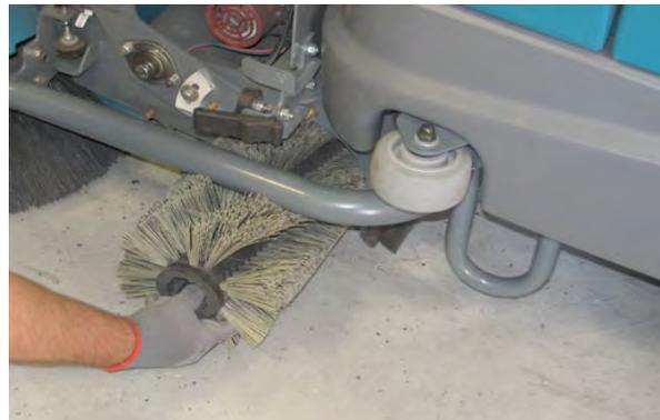
8. Guie a fenda da extremidade da nova escova em direção ao cubo de acionamento.
