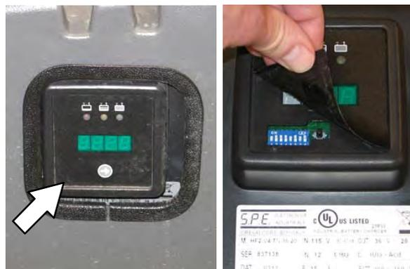
Ajuste os interruptores nas configurações corretas para as baterias.
