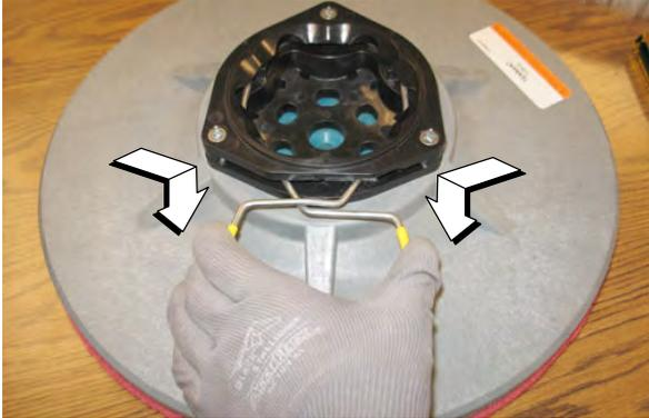
7. Empurre a nova escova sob o cabeçote de lavar, alinhe o acionamento da escova com o cubo de acionamento e levante a escova no cubo de acionamento até que a escova trave no cubo.
