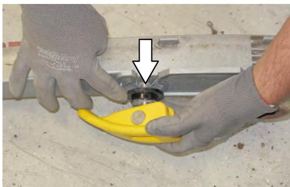
8. Remova o chassi interno do chassi externo.
