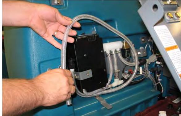
8. Desconecte a mangueira de saída do cabeçote de lavar da mangueira do coletor do ec-H2O.
