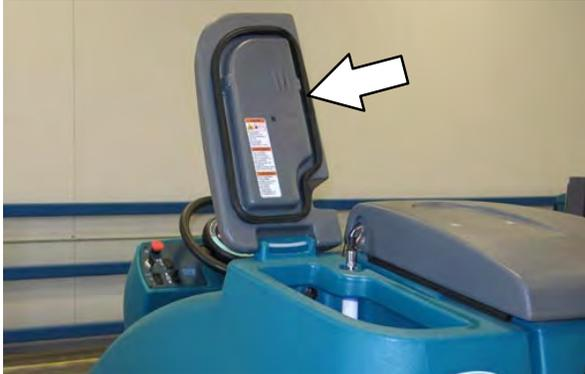
2. Encha o tanque de solução com água (sem ultrapassar 60 °C/140 °F). Encha o tanque de solução com água até que o nível seja de aproximadamente 50 mm (2 pol.) abaixo da marca indicada. Feche a tampa do tanque de solução
