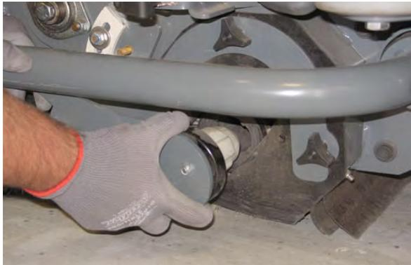
5. Remova os três manípulos que fixam a saia lateral de pré-arrimento e a placa lateral do conjunto de pré-arrimento.
