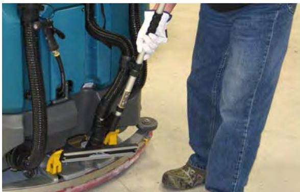
3. Insira a tampa do tubo de aspiração na abertura do tubo de aspiração.
