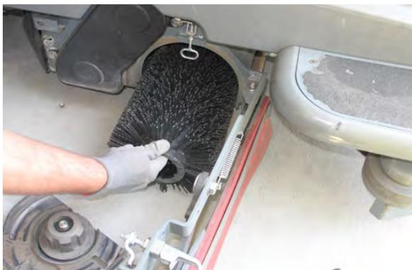
5. Posicione a escova com a *extremidade de fileira dupla em direção à abertura do cabeçote de lavar*. Direcione a nova escova sobre o cubo de acionamento.
