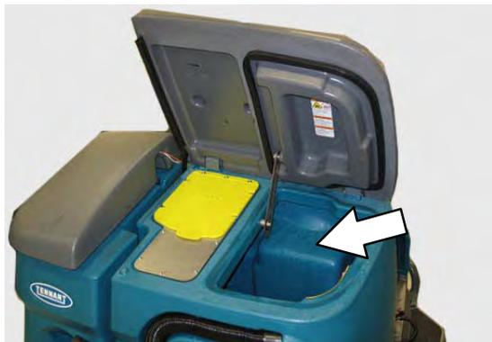
4. Encha o tanque de recuperação com água (sem ultrapassar 60 °C/140 °F). Encha o tanque de recuperação até quase no topo do filtro ES. Feche a tampa do tanque de recuperação.
