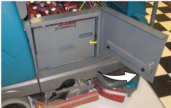
3. Desconecte o conector da máquina das baterias.
