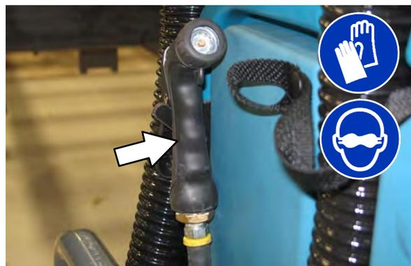
**MEDIDA DE SEGURANÇA:** Use proteção para os ouvidos e olhos ao lidar com ar ou água pressurizada.
