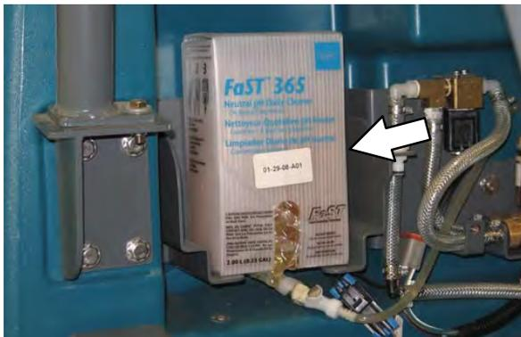
3. Rasgue as linhas perfuradas para abrir a nova embalagem FaST-PAK. NÃO remova o saco da embalagem. Retire o conector da mangueira da parte de baixo do saco e remova a tampa da mangueira.
