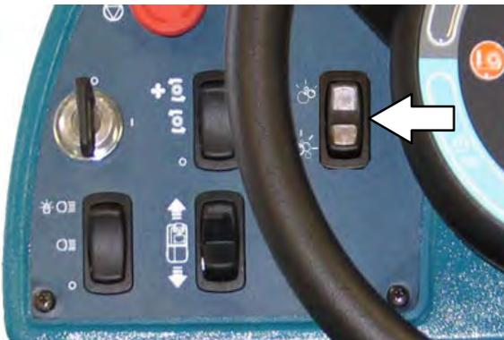
O modo de lavagem *ec-H2O* será temporariamente desabilitado quando o interruptor de ambientes severos for ativado. O modo *ec-H2O* volta automaticamente quando o tempo do *interruptor de ambientes severos* expirar/for desligado.
