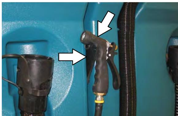
6. Pressione a parte inferior do *controle do bico de pulverização* para desligar o fornecimento de água. A luz na chave se acenderá quando o bico pulverizador estiver desligado.
