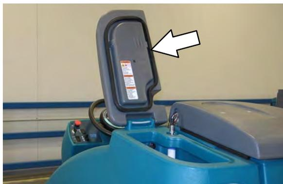
2. Encha o tanque de solução somente com ÁGUA LIMPA E FRESCA (menos de 21°C / 70°F). **NÃO** use água quente nem adicione detergentes convencionais de limpeza no chão pois isso pode causar falha no sistema FaST ou ec-H2O. Encha o tanque de solução com água até que o nível seja de aproximadamente 50 mm (2 in) abaixo do marcador de nível.
