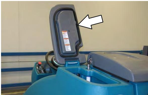
2. Encha o tanque de solução com água (não mais de 60°C / 140°F). Encha o tanque de solução com água até que o nível seja de aproximadamente 50 mm (2 in) abaixo do marcador de nível.
