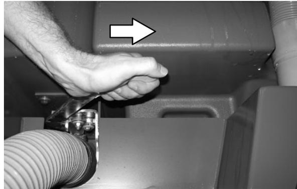
10. Reinstale a mangueira de drenagem do tanque de recuperação na parte traseira do tanque de recuperação e feche a tampa do tanque.
