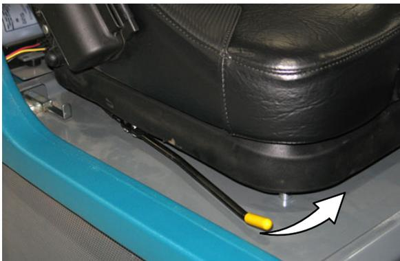
Ajuste: Empurre a alavanca na direção ao assento e deslize o assento para a posição desejada. Solte a alavanca para travar o assento na posição.
