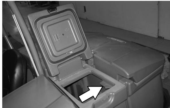
2. Abra a tampa do tanque de recuperação e encha o tanque de recuperação com água (não mais de 60°C / 140°F) até que fique cheio pela metade.
