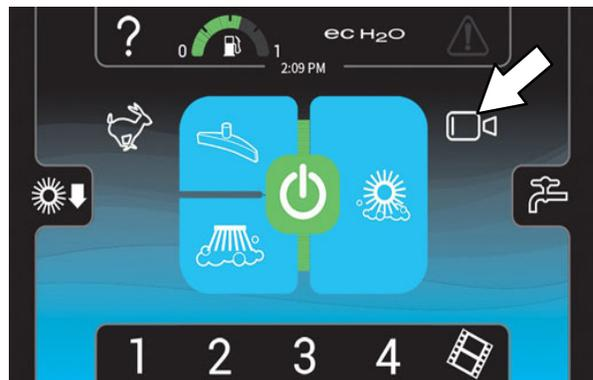
A câmera liga automaticamente quando a parte inferior do *pedal direcional* é colocada na posição de ré e permanece ligada enquanto a máquina estiver em ré.
