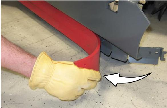
6. Instale uma nova lâmina ou gire as lâminas do rodo.
