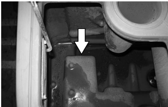
9. Feche a válvula de drenagem variável do tanque de recuperação.
