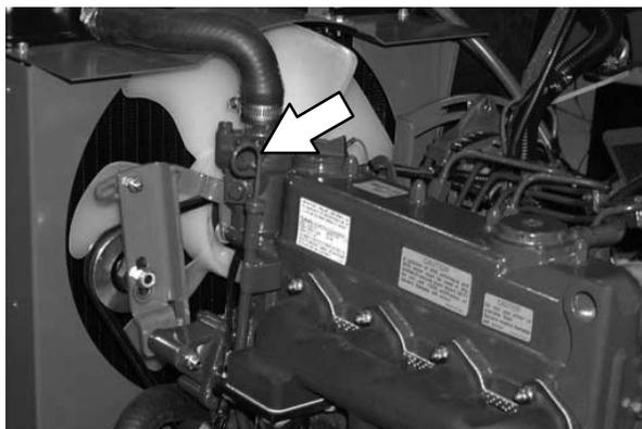
Encha o motor com óleo até a marca indicada. NÃO encha além da marca superior. A capacidade de óleo do motor é de 6 L com filtro de óleo.
