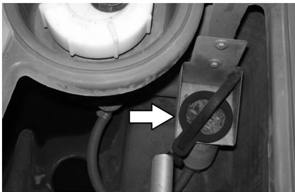
8. Enxágue a sujeira e detritos e deixe escoar pela drenagem do tanque de recuperação. Deixe o tanque de recuperação drenando por algum tempo.
