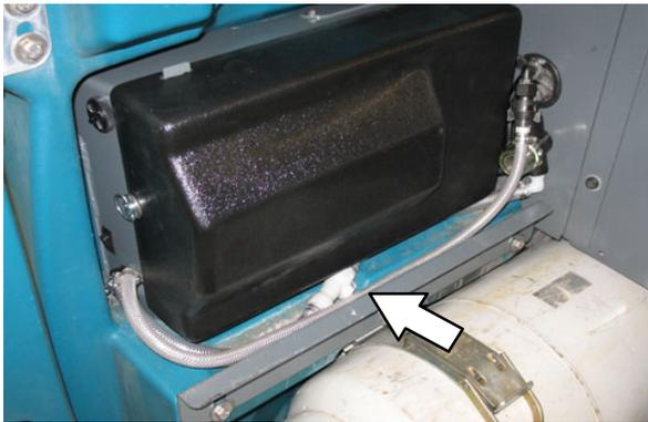
**OBSERVAÇÃO:** As mangueiras de entrada e saída devem estar rebaixadas entre o conjunto *ec-H2O* e o suporte para que não fiquem torcidas ou danificadas quando a tampa do assento do operador estiver fechada.
