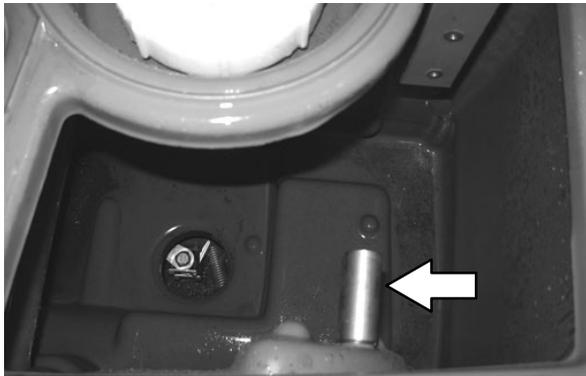
7. Máquinas ES: Enxágue o filtro ES. Se necessário, remova o filtro ES do tanque de recuperação.
