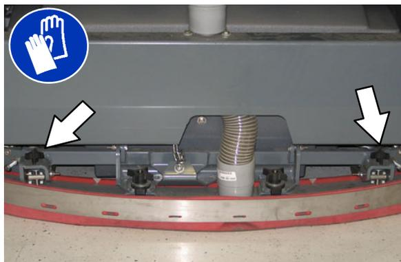
4. Após ajustar, mova novamente a máquina para a frente para verificar a deflexão da lâmina do rodo.
