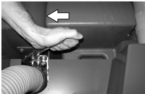
4. Enxágue a sujeira e os detritos, escoe-os através da abertura de drenagem da bandeja e lave a mangueira do aspirador.
