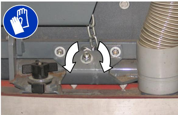
4. Gire a porca de nivelamento do rodo no -sentido anti-horário para diminuir a deflexão nas extremidades da lâmina do rodo.
