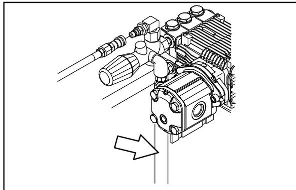
Opere a lavadora de alta pressão por alguns segundos para eliminar o anticongelante da bomba. Solte o gatilho por alguns segundos o que drenará o anticongelante da linha de retorno para dentro do balde. Desligue o interruptor da lavadora à pressão, reduza a velocidade do motor e reconecte a linha de retorno ao tanque de solução.
