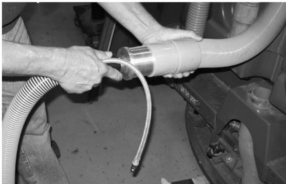
4. Prenda a mangueira de solução para o encaixe de desconexão rápida. Empurre o conector até que ele pare. Puxe a mangueira para garantir que ela está conectada.
