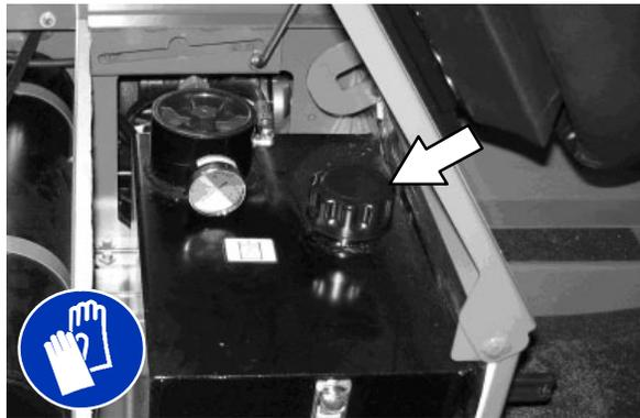
Substitua o filtro de fluido hidráulico a cada 1.200 horas de operação ou quando o visualizador de nível do reservatório hidráulico estiver na zona amarela/vermelha quando o fluido hidráulico do reservatório estiver a cerca de 32° C (90° F).
