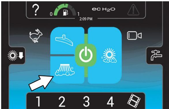
Ligar o fluxo da solução: Pressione o *botão de liga/desliga da solução*. Os indicadores da solução voltarão a ligar e o fluxo da solução voltará ao último ajuste usado.
