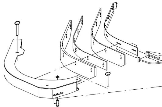
**OBSERVAÇÃO:** As lâminas do rodo da escova lateral têm diferentes furos para alterar o ajuste de altura.
