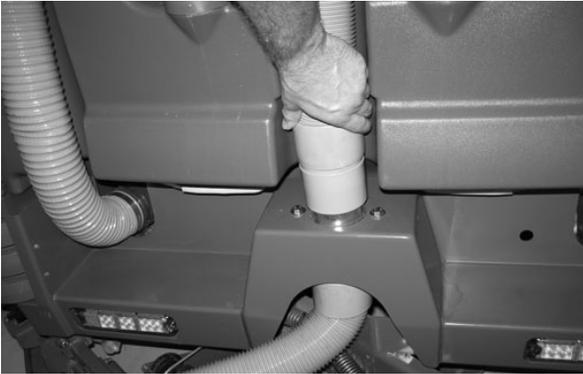
9. Borrife água através do orifício localizado no interior do acoplamento de vácuo para lavar os detritos da bandeja.
