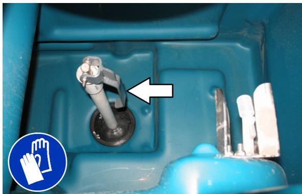
4. Abra a válvula de drenagem variável do tanque de recuperação.
