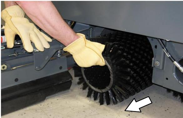
6. Ao instalar ou girar escovas, empurre suas extremidades e encaixe-as nos cubos de acionamento do motor de propulsão.
