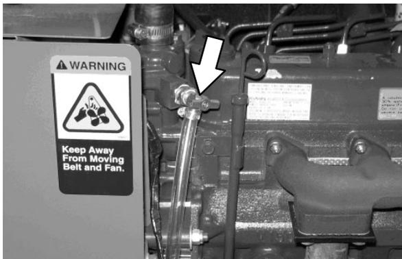
Verifique as mangueiras e abraçadeiras do radiador após cada 200 horas de operação. Aperte quaisquer abraçadeiras frouxas. Substitua mangueiras e abraçadeiras danificadas.
