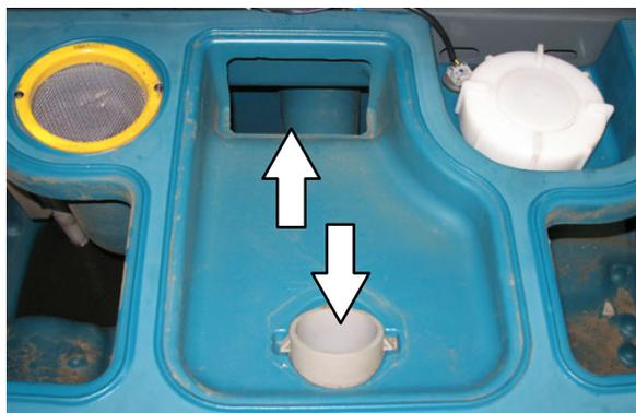
**OBSERVAÇÃO:** NÃO use jatos de vapor para lavar os tanques. O calor excessivo pode causar danos aos tanques e componentes.
