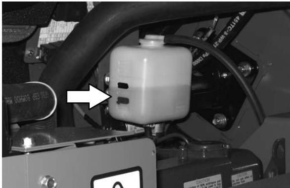
Drene o radiador e o sistema de arrefecimento após cada 800 horas de operação.
