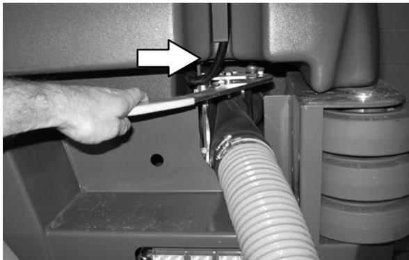
6. Feche a válvula de drenagem variável do tanque de solução.
