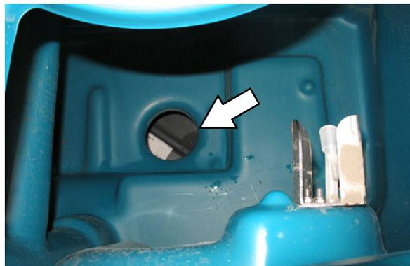
7. Limpe a abertura de drenagem e coloque novamente o plugue de drenagem. Empurre a alça para baixo para fechar. O plugue deve estar totalmente posicionado antes de empurrar a alça.
