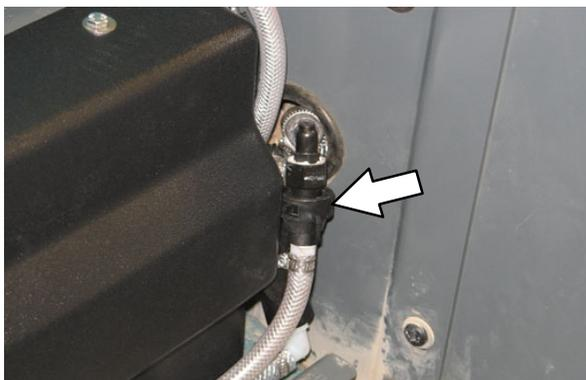
9. Sopre ar pressurizado (menor que 344 kPa (50 psi)) na mangueira de saída do sistema ec-H2O. Continue soprando ar pressurizado na mangueira de saída até que não saia mais água do tubo de drenagem.
