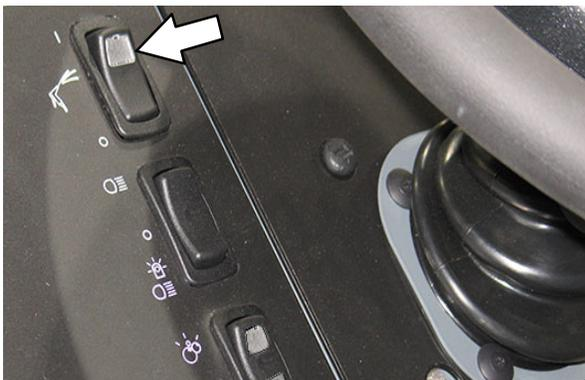
10. Coloque a chave na posição desligada.
