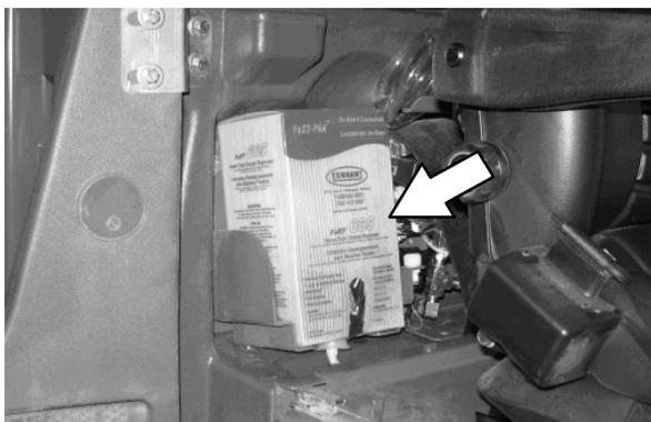
No modo opcional ES (lavagem prolongada), a solução suja no tanque de recuperação é filtrada através do sistema ES de volta ao tanque de solução para ser reutilizada. Em seguida, é injetado um detergente na solução para fortalecer sua capacidade de limpeza.
