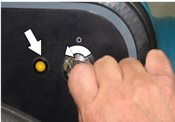
**OBSERVAÇÃO:** Não opere o motor de partida por mais de 10 segundos de cada vez ou após ter iniciado o motor. Deixe o motor de partida resfriar de 15 a 20 segundos antes de tentar de novo para evitar danos ao motor.
