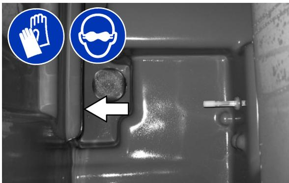
7. Reinstale a mangueira de drenagem do tanque de solução na parte traseira do tanque de recuperação.
