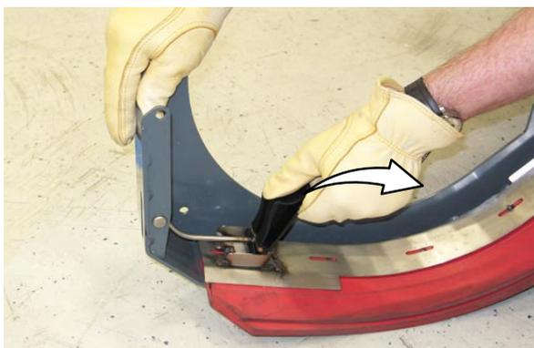
4. Remover os rodos, espaçador e receptáculo do protetor do rodo.
