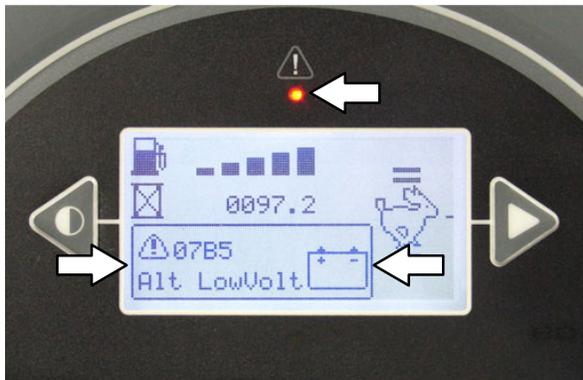
O indicador do LCD exibirá um código de falha/alerta. Se houver mais de uma falha, cada código de falha será mostrado alternativamente.
