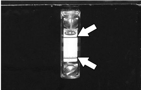
**ATENÇÃO!** Não encha demais o reservatório de fluido hidráulico nem opere a máquina se o nível de fluido no reservatório estiver baixo. Isso pode causar danos ao sistema hidráulico da máquina.
