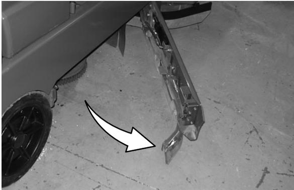
3. Inspeccione os protetores de paragem do cabeçote da escova. Ajuste os protetores se o cabeçote da escova não estiver paralelo ao chão. Substitua protetores danificados ou desgastados.
