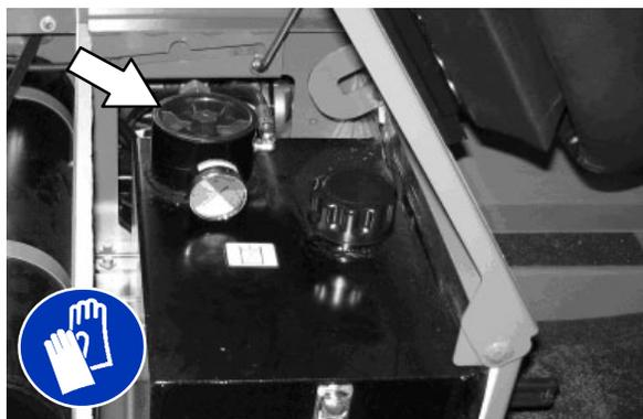
Substitua o filtro hidráulico de saída a cada 2400 horas de operação.
