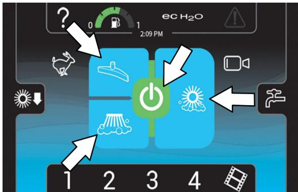
**OBSERVAÇÃO:** NÃO ative o sistema FaST ou ec-H2O durante a lavagem convencional. Detergentes de limpeza convencional podem causar falha no sistema FaST ou ec-H2O. Drene, enxágue e encha novamente o tanque de solução com água limpa e fresca antes de operar o sistema FaST ou ec-H2O.
