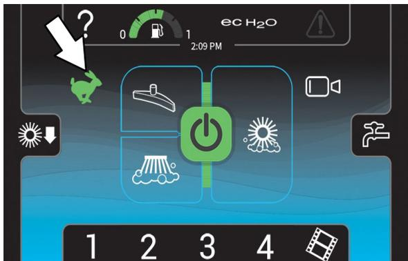
O *botão de velocidade do motor* está desligado quando o motor estiver definido em baixa velocidade.
