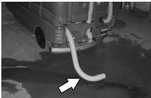
3. Abra a válvula de drenagem variável do tanque de recuperação.
