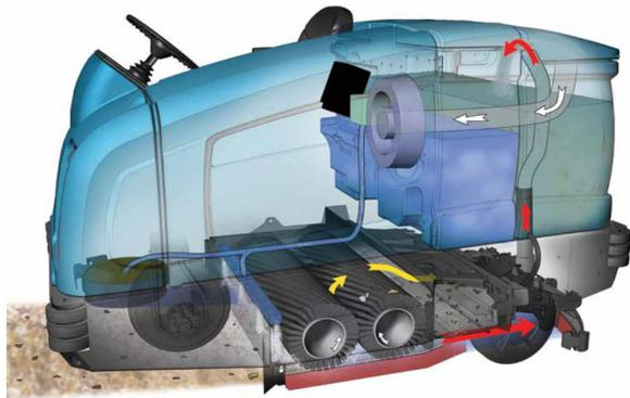
Esta máquina foi projetada para lavar superfícies sujas com eficácia. O botão *1-STEP* permite o início imediato da lavagem através da operação de todas as funções de lavagem e varrição.
