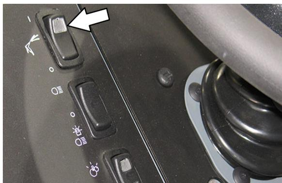
12. Coloque a chave na posição desligada.
