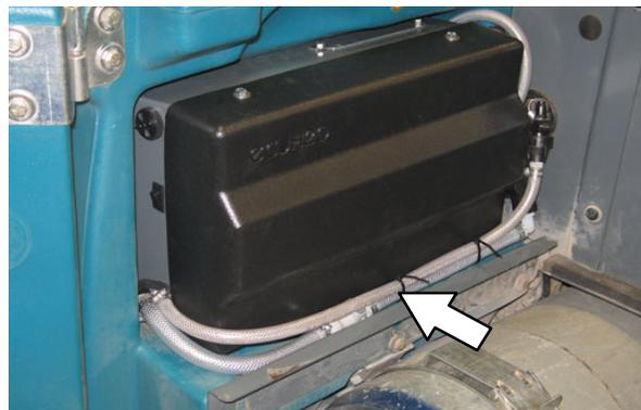
13. Coloque novamente a mangueira de enxágue de entrada para o saco atrás do assento do operador.
