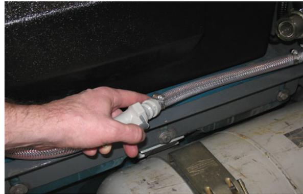
4. Puxe o tubo de drenagem entre a unidade ec-H2O e o compartimento do operador, remova a tampa do tubo e coloque a extremidade do tubo em um recipiente vazio. Coloque a tampa de lado.
