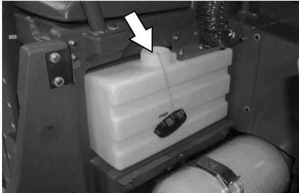
Ao lavar, pressione a parte superior do interruptor para aumentar o fluxo do detergente. Pressione a parte inferior do interruptor para um fluxo ainda maior de detergente. A luz no interruptor exibe qual ajuste está ativo.
