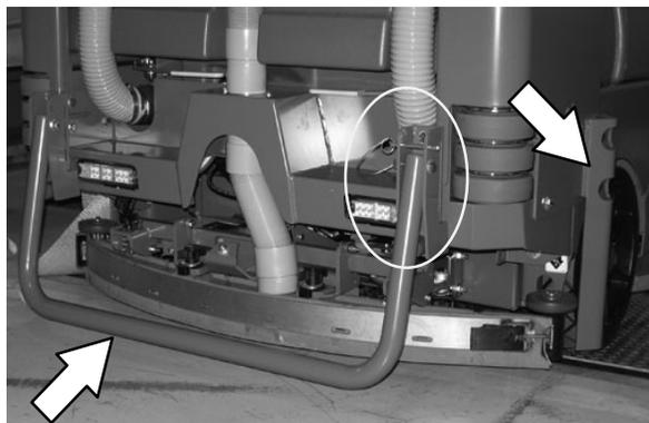
Para usar o protetor do rodo traseiro, puxe o parafuso, rebaixe a barra do protetor e reinsira o parafuso.
