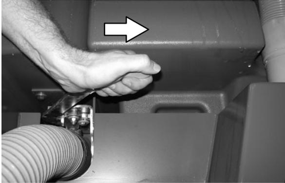
9. Reinstale a mangueira de drenagem do tanque de recuperação na parte traseira do tanque.
