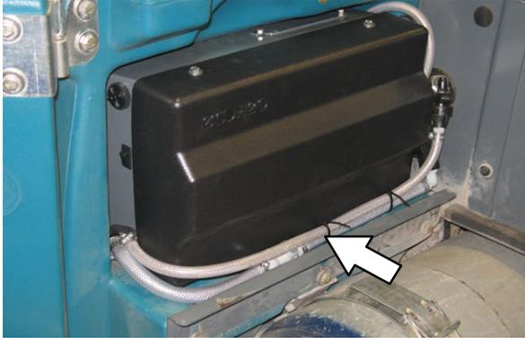
*OBSERVAÇÃO: As mangueiras de entrada e saída devem estar rebaixadas entre o conjunto ec-H<sub>2</sub>O e o suporte para que não fiquem torcidas ou danificadas quando a tampa do assento do operador estiver fechada.*
