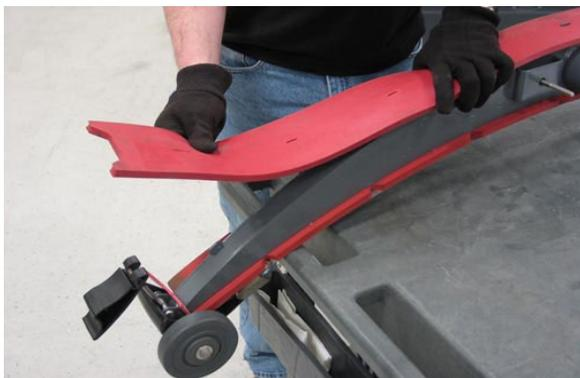
8. Instale a nova lâmina do rodo traseiro ou gire o lâmina existente para usar outra borda. Certifique-se de posicionar todos os furos da lâmina do rodo nas guias.
