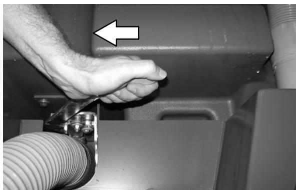
5. Remova a mangueira localizada na parte posterior do tanque de recuperação e enxágue-a para remover a sujeira e os detritos.
