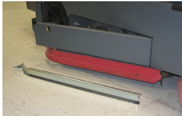
5. Remova a lâmina do rodo lateral. Se a borda externa da lâmina do rodo estiver gasta, gire a lâmina para o outro lado da máquina. Jogue fora a lâmina do rodo se ambas as bordas estiverem gastas.
