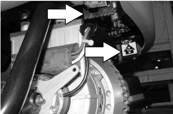
Os pontos traseiros para a colocação de um macaco estão localizados de ambos os lados da máquina nos eixos.
