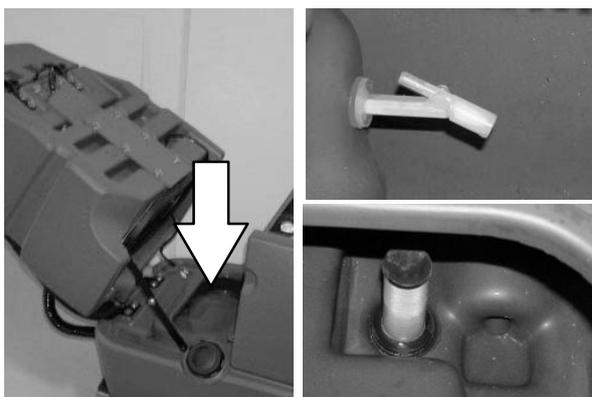
13. Com cuidado, empurre o depósito de recuperação para a frente para fechar o depósito de solução.
