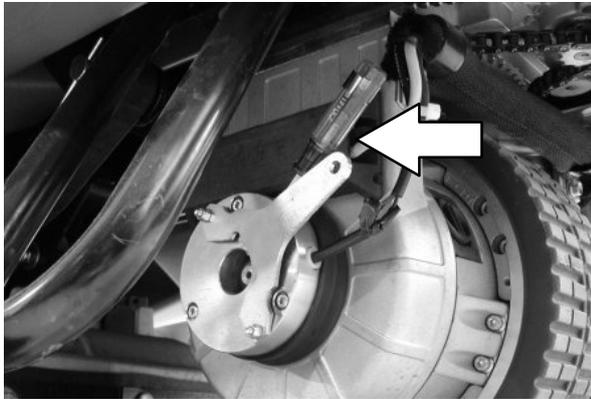
Para modelos fabricados antes do número de série 00681, o conector da cablagem do motor de propulsão também tem de ser desligado.
