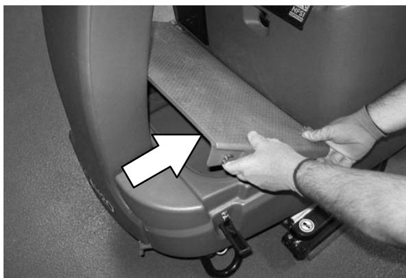
16. Cabeça de esfrega cilíndrica: Retire e limpe o recipiente do lixo. Coloque o recipiente de novo na cabeça de esfrega quando tiver terminado.
