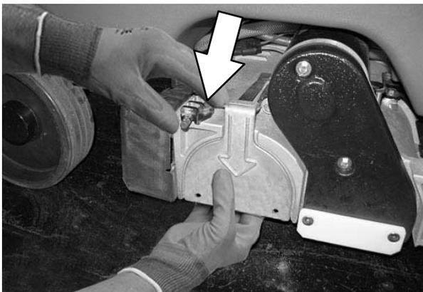
5. Segurando na extremidade plana do eixo do prato da embraiagem com uma chave, desaperte o parafuso de montagem do lado de fora da porta do prato da embraiagem.
