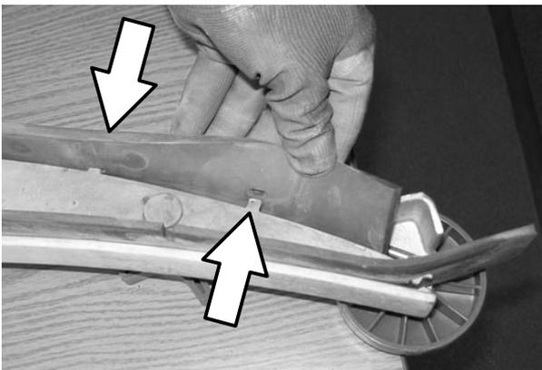
11. Volte a instalar a faixa de retenção do rodo traseiro no conjunto do rodo. Certifique-se de que cada uma das flanges na faixa de retenção se encaixa nos entalhes existentes no conjunto do rodo traseiro.
