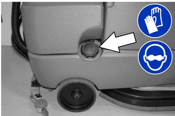
3. Desligue o encaixe conector preto da cabeça de lavagem e coloque a mangueira num balde.
