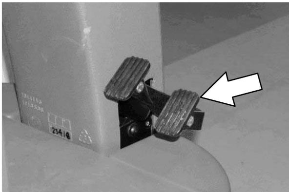
7. Liberte o pedal de propulsão para parar a máquina. As funções de esfrega param e o travão de estacionamento automático é aplicado quando a máquina pára.
