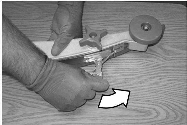
6. Retire a lâmina do rodo traseiro do conjunto do rodo traseiro.
