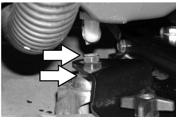
5. Conduza novamente a máquina para a frente para voltar a verificar a deflexão da lâmina do rodo após os ajustes.
