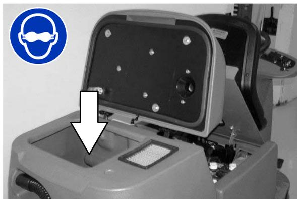
6. Enxagúe o sensor de bóia localizado no interior do depósito de recuperação.
