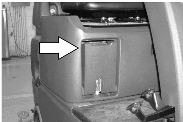
4. Aperte o botão no conector da mangueira de alimentação FaST e, em seguida, puxe a embalagem de FaST-PAK vazia para fora do compartimento.
