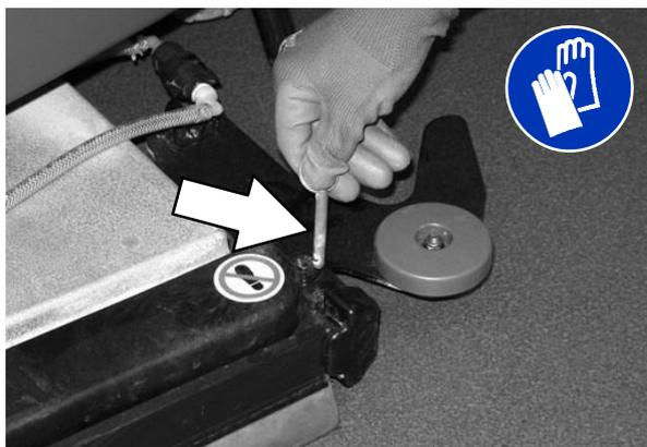
4. Abra a articulação de retenção do rodo lateral na direcção da parte da frente da máquina e, em seguida, puxe o rodo lateral na direcção da parte de trás da máquina para aceder às escovas ou acessórios.
