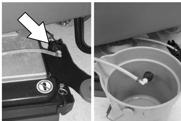
4. Prima e liberte o interruptor do módulo *ec-H2O* para drenar o anticongelante do sistema *ec-H2O*.
