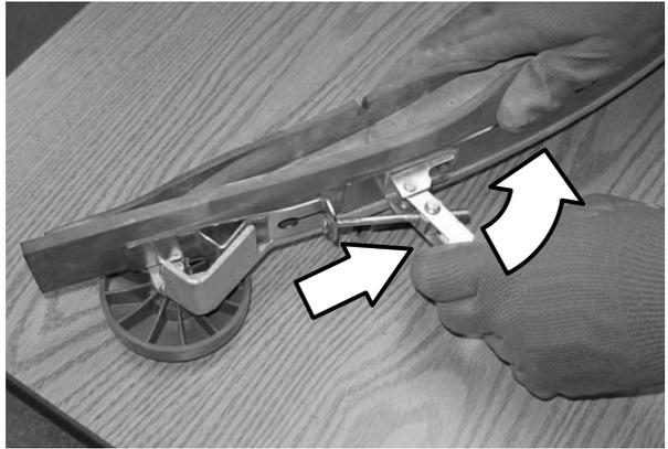
13. Volte a instalar o rodo traseiro por baixo do suporte de montagem do rodo e aperte os quatro manípulos.
