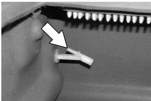
7. Volte a colocar a tampa da mangueira de drenagem do depósito de recuperação e monte a mangueira novamente no suporte de arrumação após a drenagem do depósito.
