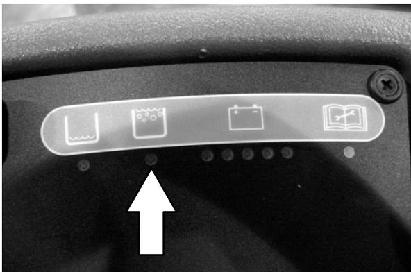
*NOTA: Não carregue as baterias mais vezes do que o necessário. O carregamento excessivo pode reduzir a vida útil das baterias. É melhor carregar as baterias apenas quando a luz esquerda indicar que a bateria precisa de ser carregada. Consulte a secção BATERIAS na secção MANUTENÇÃO.*
