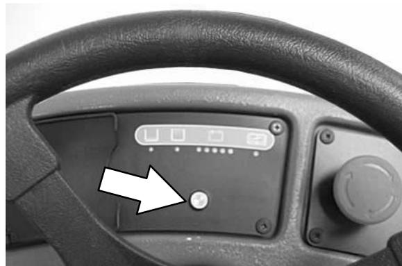
**Modelo ec-H2O:** Se soar um alarme e a luz indicadora do sistema ec-H2O começar a piscar a vermelho, o módulo do ecH2O tem de ser drenado para retomar o funcionamento do sistema ec-H2O (ver PROCEDIMENTO DE DRENAGEM DO MÓDULO DO ec-H2O).
