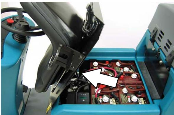
NOTA: certifique-se de que as baterias têm o nível adequado de eletrólito antes do carregamento. Consulte VERIFICAR O NÍVEL DO ELETRÓLITO.
