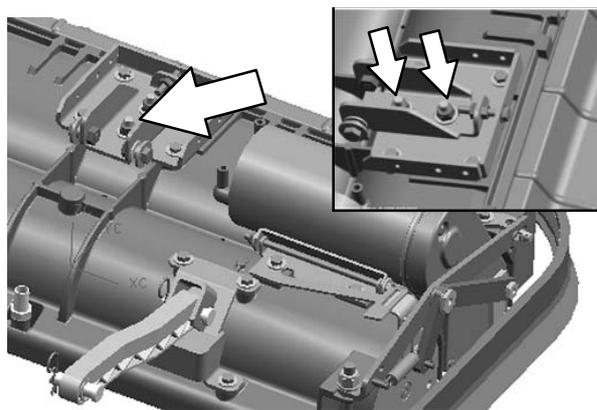
4. Desaperte a porca e depois ajuste o parafuso de ajuste da largura da escova. Aperte a porca e os dois parafusos de montagem da cabeça de esfrega quando tiver terminado.
