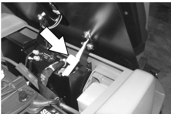
4. Retire a mangueira de drenagem do depósito de recuperação. Segurando a mangueira para cima, retire a tampa e, em seguida, baixe a mangueira de drenagem devagar até à conduta de drenagem no chão ou ao lavatório.
