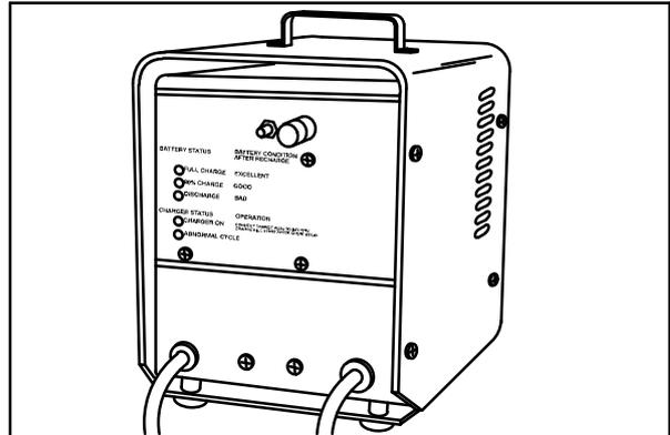
6. O carregador TENNANT começará a funcionar automaticamente. Quando as baterias tiverem a carga completa, o carregador TENNANT desligar-se-á automaticamente.
