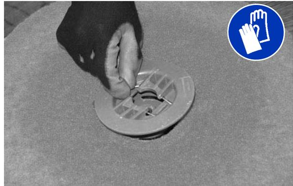
3. Volte ou substitua o acessório de esfrega e centralize o mesmo no suporte de acessórios. Em seguida, volte a instalar o disco central para fixar o acessório no suporte de acessórios.
