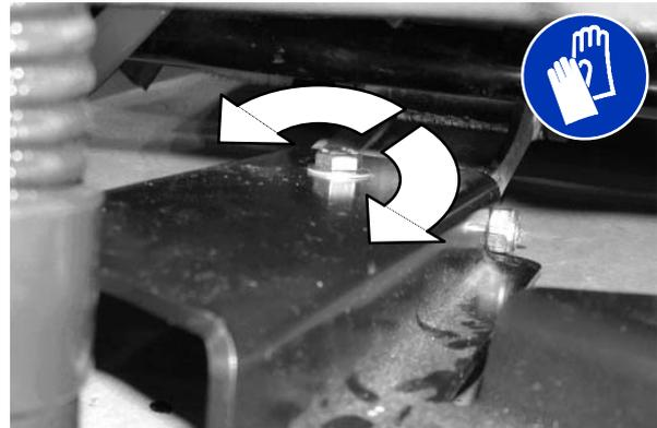
Rode o perno de nivelamento do rodo no sentido contrário ao dos ponteiros do relógio para aumentar a deflexão nas extremidades da lâmina.
