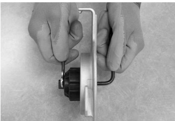
6. Rode o eixo do prato da embraiagem para levantar ou baixar a extremidade da escova conforme necessário para endireitar o padrão das escovas. Aperte o parafuso de montagem.
