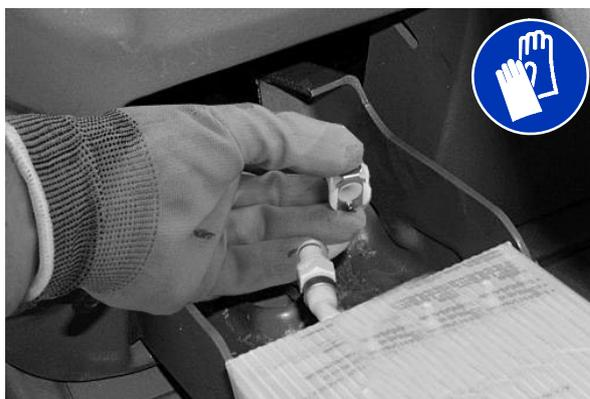
5. Retire o pedaço perfurado da nova embalagem de FaST-PAK. Não retire o saco da embalagem. Puxe para fora o conector da mangueira localizado na parte inferior do saco e retire a tampa da mangueira do conector.
