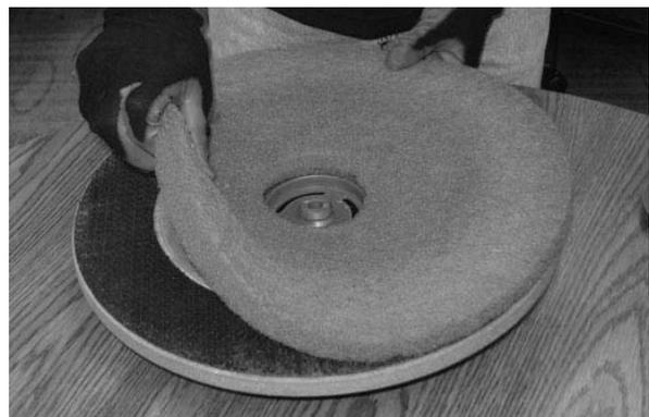
4. Volte a inserir o suporte de acessórios na máquina.
