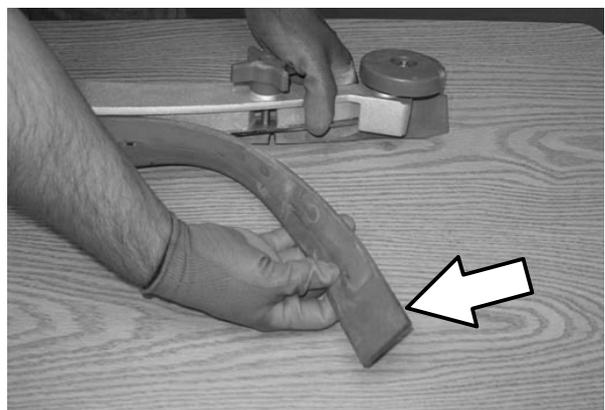
7. Desaperte os dois manípulos externos no conjunto do rodo traseiro. Retire a lâmina da frente do rodo do conjunto do rodo.
