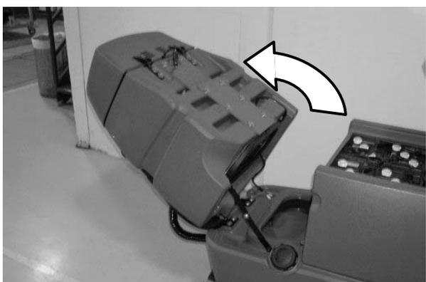
12. Enxagúe o depósito de solução e o sensor de bóia localizado na parte de trás do depósito de solução. Enxagúe o filtro de rede na parte inferior do depósito.
