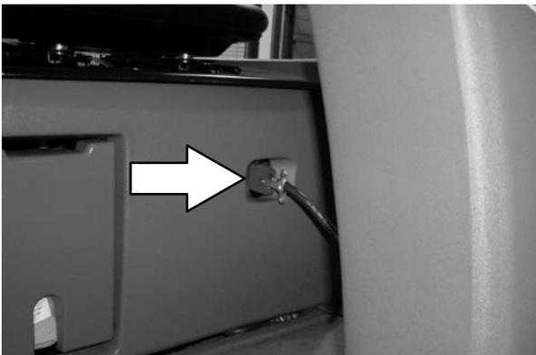
5. Ligue o carregador a uma tomada de parede.
